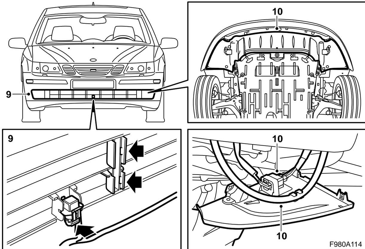
9 Installare il sensore di temperatura e la griglia inferiore. Controllare che le linguette di bloccaggio facciano buona presa.
